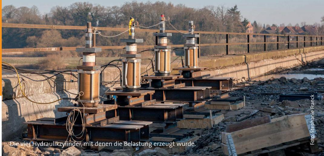
Die vier Hydraulikzylinder, mit denen die Belastung erzeugt wurde.
