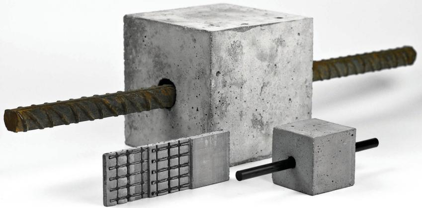
Demonstratoren: Vergleich Stahl- und Carbonstab sowie Textilbeton
