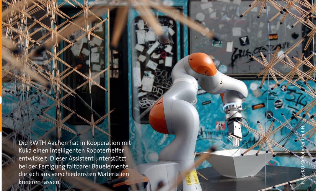
Die RWTH Aachen hat in Kooperation mit Kuka einen intelligenten Roboterhelfer entwickelt. Dieser Assistent unterstützt bei der Fertigung faltbarer Bauelemente, die sich aus verschiedensten Materialien kreieren lassen.
